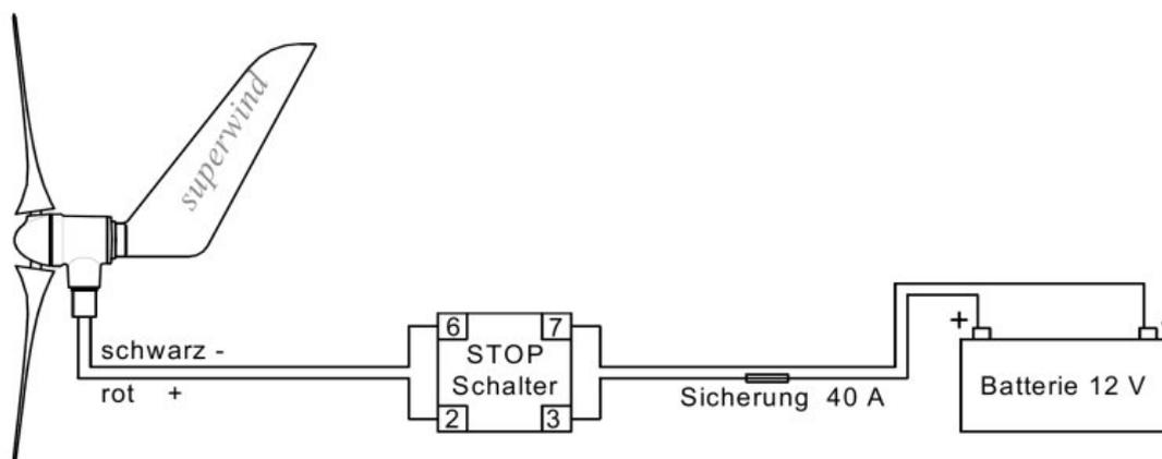
Das Schema zeigt den Anschluss des Stop-Schalters ohne den optionalen Marine-Laderegler.
