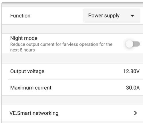
Um das Ladegerät wieder als normales Batterieladegerät zu verwenden, befolgen Sie die Schritte 1 bis 3 oben und wählen Sie dann den Modus „Ladegerät“ aus dem Auswahlmenü „Funktion“.
