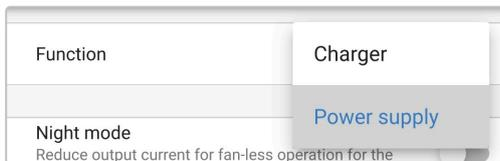
6. Der Modus „Stromversorgung“ wird nun aktiviert. Nach der Aktivierung leuchten die LEDs BULK, ABS, FLOAT und STORAGE.
