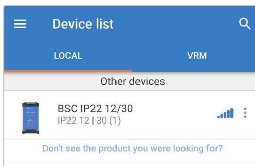
6. Während der anfänglichen Verbindung erscheint eine „Bluetooth-Kopplungsanforderung“, bei der Sie nach dem Bluetooth-PIN-Code gefragt werden. Geben Sie den Standard-PIN-Code 000000 ein und wählen Sie „Koppeln“.
