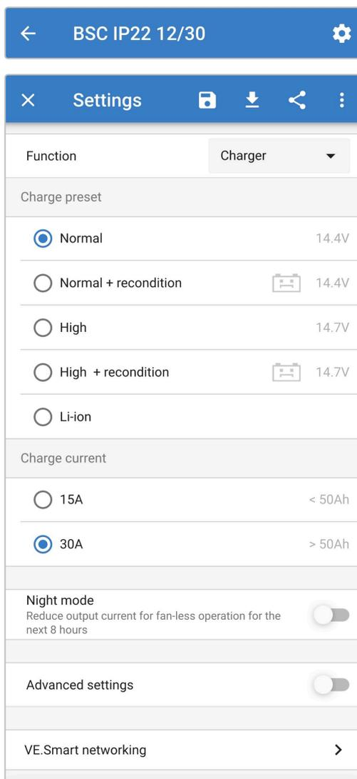
8. Wählen Sie aus den integrierten Ladevoreinstellungen (Normal, Normal + Wiederherstellung, Hoch, Hoch + Wiederherstellung oder Lithium-Ionen) im Menü „Ladevoreinstellung“ den am besten geeigneten Modus aus. Die LED neben dem aktuell gewählten Lademodus (NORMAL / HIGH / LI-ION) leuchtet auf, ebenso wie die RECONDITION-LED, wenn diese aktiviert ist.
